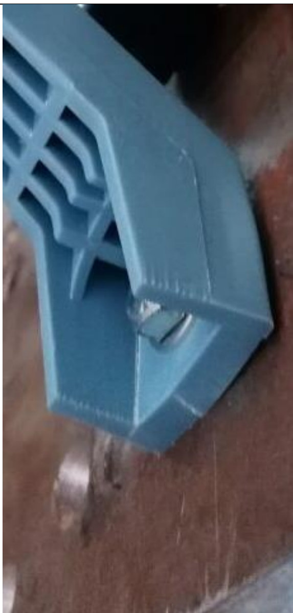
Ruine par flexion de l'équerre au droit de la vis
